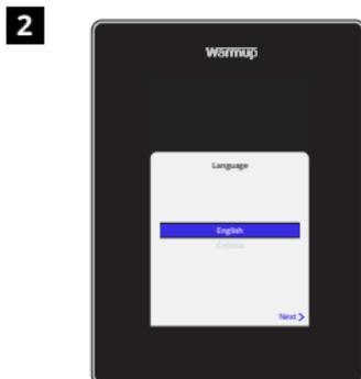
Remettez l'écran en place jusqu'à ce qu'un « clic » se fasse entendre. Remettez le circuit sous tension et mettez le thermostat sous tension. Suivez les instructions à l'écran pour configurer le système. Une fois configuré, un code QR apparaîtra.
