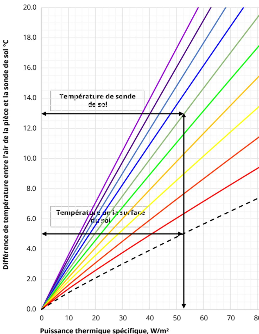
La pièce dont la température de l'eau est la plus élevée définit la température de conception de l'eau pour l'ensemble du système en fonction des calculs de la section précédente.
