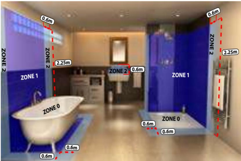
**NOTE:** Dans le cadre d'une installation dans une pièce humide et d'après la NF C 15-100, il est interdit d'installer en Zones 0 et 1 tout appareil électrique comme les thermostats, contacteur de puissance, boîte de jonction.
