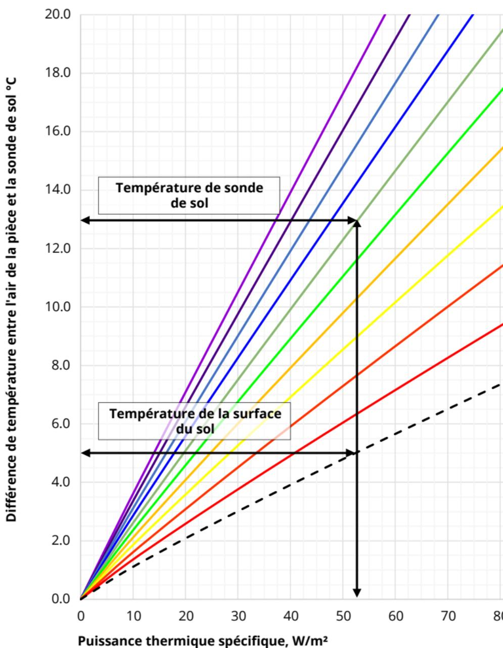
L'exemple ci-dessus montre une température ambiante de conception de 20 °C et une température de surface du sol de 25 °C. Sur la base d'une différence de température de 5 °C, la puissance calorifique résultante serait de 52,5 W/m. Sur la base d'une finition de sol de 0,15 m<sup>2</sup>.k/W (1,5 Tog), la sonde de sol doit être réglée sur 33 °C pour obtenir cette puissance calorifique.
