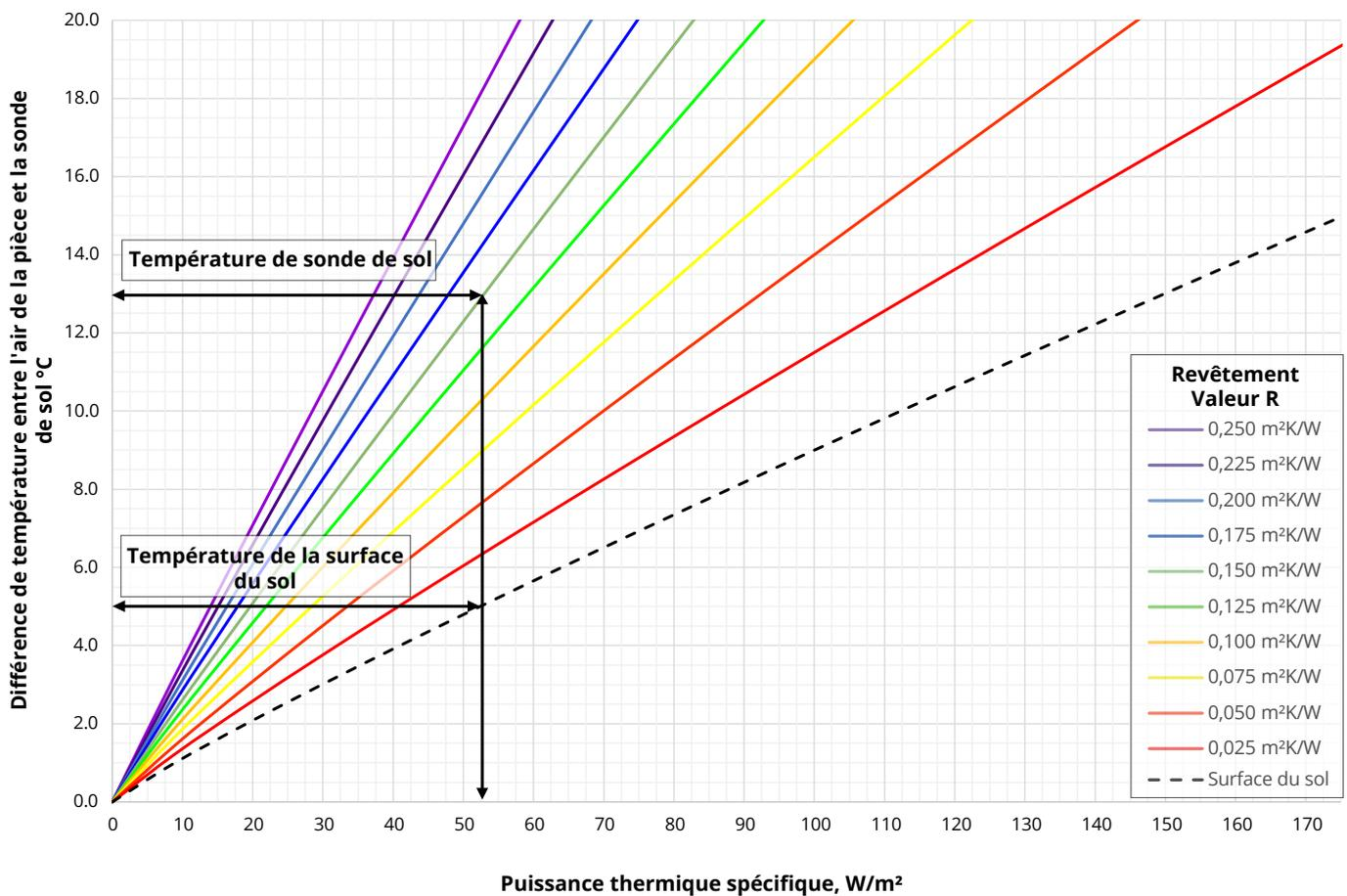
À l'aide du graphique ci-dessus, il est possible d'obtenir la puissance calorifique spécifique d'un système de chauffage électrique par le sol en fonction de la différence de température entre la température de l'air ambiant et la température de la sonde du sol, selon la finition du sol.
