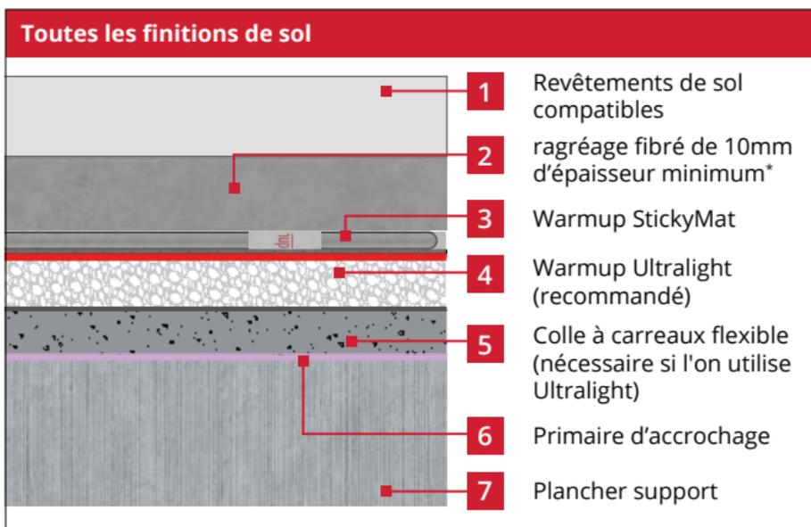
\* Cette méthode peut être utilisée pour créer une surface de sol adaptée à la plupart des finitions de sol. Le ragréage fibré, lorsqu'il est utilisé, doit être appliqué en une seule couche, le multi couche n'est pas autorisé. Vérifiez auprès du fabricant de revêtement de sol si le produit convient au chauffage par le sol.
