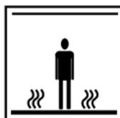
Les câbles électriques et les trames chauffantes sont dans le sol. NE PAS percer avec des clous, des vis ou des appareils similaires. NE PAS limiter l'émission thermique du sol chauffé.
