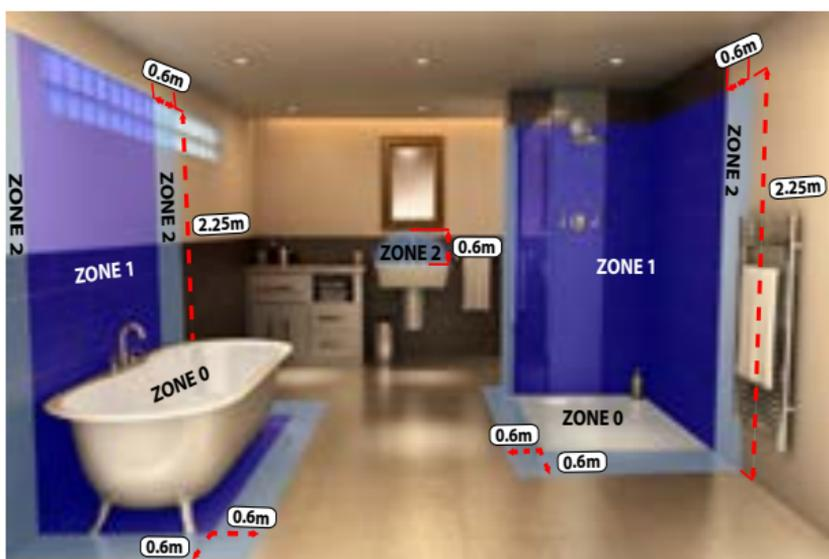
**REMARQUE** : Dans le cadre d'une installation dans une pièce humide et d'après la NF C 15-100, il est interdit d'installer en Zones 0 et 1 tout appareil électrique comme les thermostats, contacteur de puissance, boîte de jonction.
