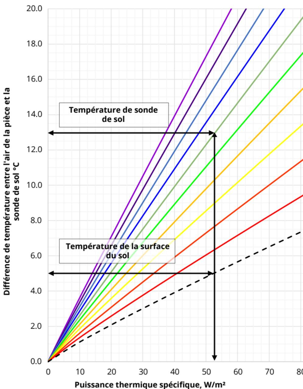
À l'aide du graphique ci-dessus, il est possible d'obtenir la puissance calorifique spécifique d'un système de chauffage électrique par le sol en fonction de la différence de température entre la température de l'air ambiant et la température de la sonde du sol, selon la finition du sol.
