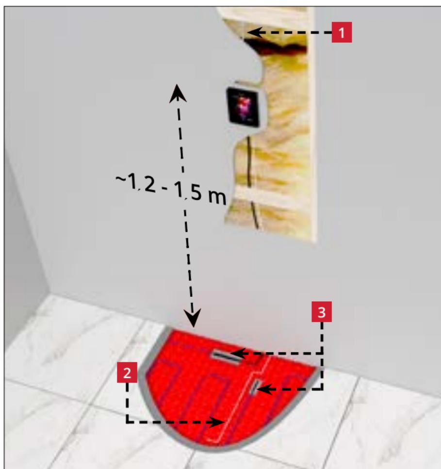
**1** L'alimentation du thermostat DOIT être protégée par un dispositif différentiel à courant résiduel (DDR) 30mA à tout moment. Les Différentiels à temporisation ne doivent pas être utilisés. Un maximum de 7,5 kW de chauffage doit être connecté à chaque DDR de 30 milliampères. Pour des charges plus importantes, utilisez plusieurs DDR.
