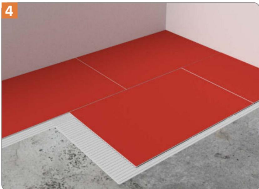
L'ultralight doit être posé sur le mortier colle fraîchement appliqué et soigneusement appliqué afin de s'assurer qu'aucun vide n'est laissé sous les planches et qu'elles sont solidement soutenues. Tous les panneaux doivent être posés avec des joints décalés.
