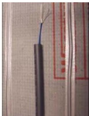
6. Aux deux extrémités du câble, utiliser le dénudeur de fil ou le couteau pour retirer environ 7 mm de l'isolation qui recouvre les âmes.
