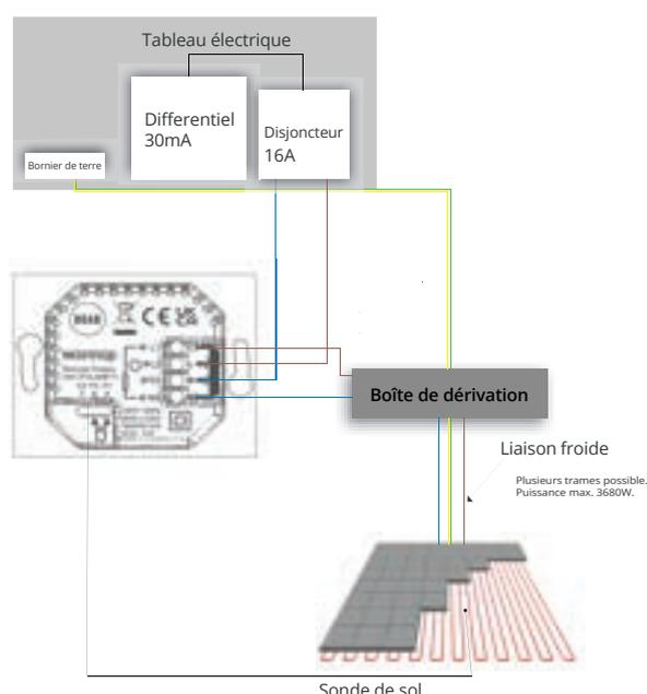
Pour une installation inférieure à 16A (3680W), la phase et le neutre de l'alimentation de la trame chauffante seront respectivement raccordés aux bornes L1 et N4. Le thermostat sera alimenté aux bornes L2 et N3 via un disjoncteur 16A.
